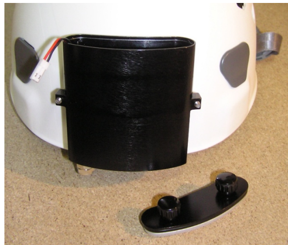
Caja de acumuladores montada
